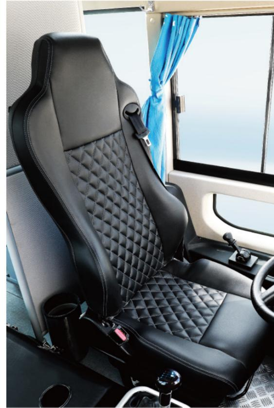
El asiento conductor con suspensión neumática tiene ricas funciones de ajuste, mejorando la comodidad y aliviando la fatiga al conducir.
